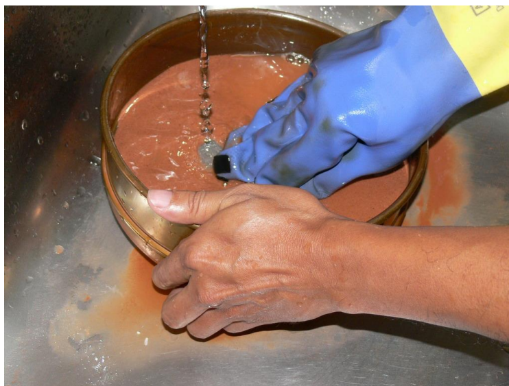
การทดสอบการร่อนผ่านตะแกรง Wet Sieve Analysis
