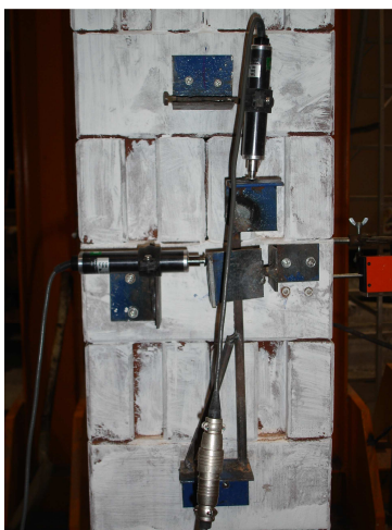
ภาพที่ 5 การติดตั้งอุปกรณ์วัดการเปลี่ยนแปลงรูปร่างของเสา
