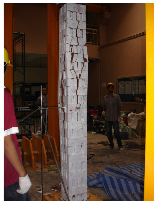
ภาพที่ 7 ลักษณะการวิบัติของเสาบล็อกประสานแบบเสริมเหล็ก
