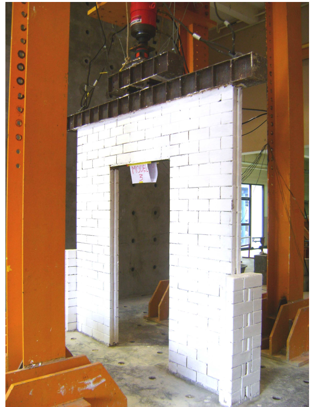
ภาพที่ 4 ผนังบล็อกประสานที่พร้อมทำการทดสอบ
