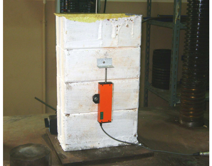
ภาพที่ 5 การทดสอบปริซึมเพื่อหากำลังรับแรงอัดของบล็อกประสาน
