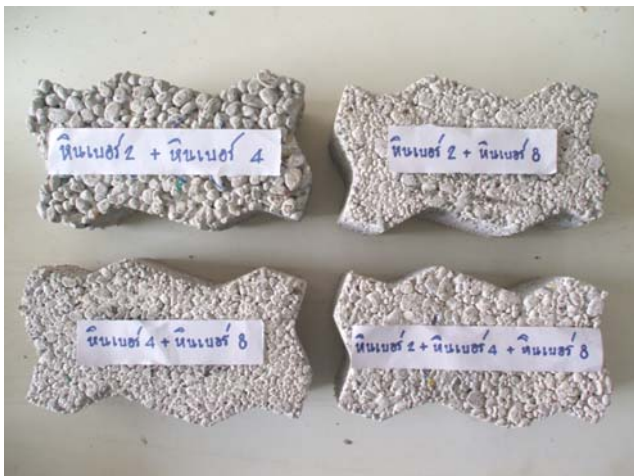
ภาพที่ 6.6 บล็อกปูถนนคอนกรีตพูนที่ใช้เปอร์เซ็นต์ปูนซีเมนต์ 20 % และอัตราส่วนน้ำต่อปูนซีเมนต์เท่ากับ 0.40
