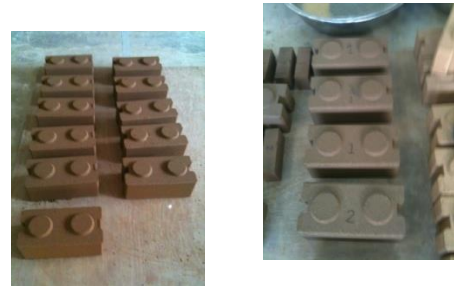
รูปที่ 1 ลักษณะบล็อกประสานอัตราส่วนผสมมาตรฐาน (ซ้าย) และบล็อกประสานอัตราส่วนผสมวัสดุเหลือใช้ (ขวา)
