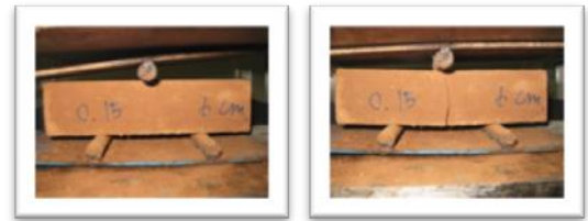
ภาพที่ 4 สภาพการวิบัติของบล็อกดินซีเมนต์เสริมใยไฟ
