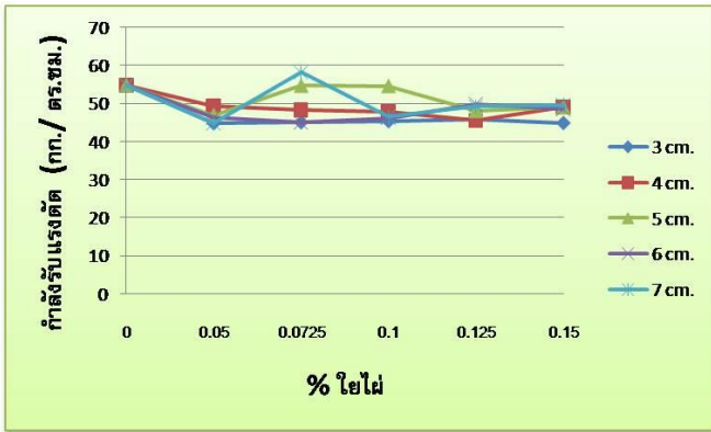
ภาพที่ 7 กราฟแสดงกำลังรับแรงดัดของบล็อกคินซีเมนต์ผสมโยไฟ อายุการบ่ม 28 วัน
