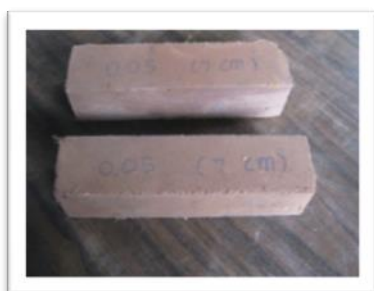
ภาพที่ 3 บล็อกดินซีเมนต์เสริมใยไฟ ขนาด 4x16x4 cm.
