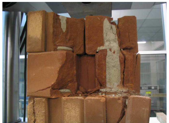
ภาพที่ 4 กำลังอัดของปริซึมบล็อกประสานเชื่อมประสานด้วยปูนเกร้าที่ทรายหยาบ
