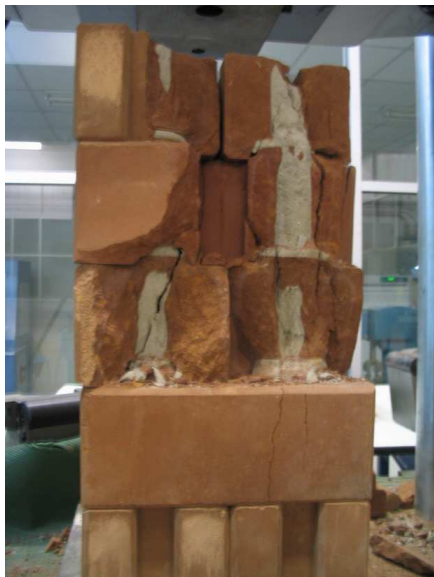
ภาพที่ 10 การวัดของปูนเกร้าท์ที่เชื่อมประสานทำให้การวัดของบล็อกประสานเกิดขึ้นแบบทันทีทันใด
