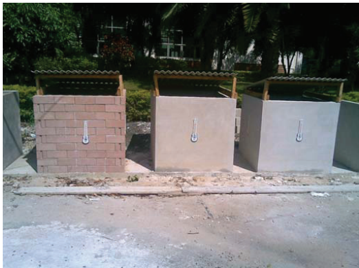
ภาพที่ 6 แบบจำลองที่ทำกรทดลองเก็บข้อมูลอุณหภูมิ
