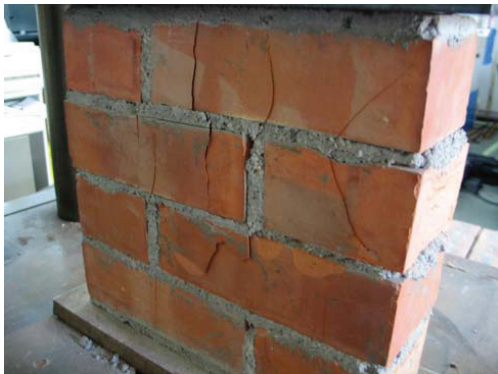
ภาพที่ 13 การวิบัติของแท่งปริซึมอิฐทนไฟ
