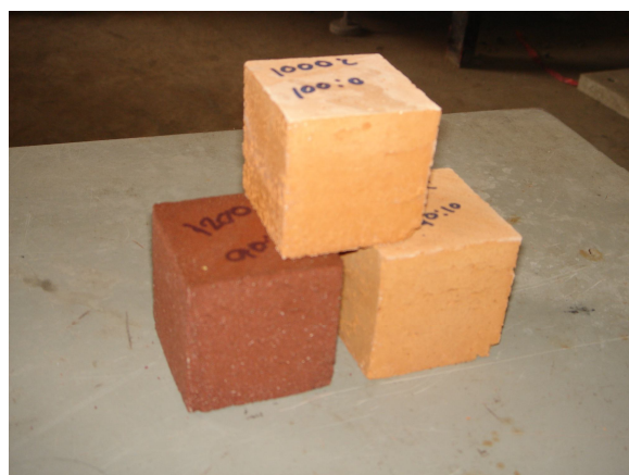
รูปที่ 1 มวลรวมประคิษฐ์ทรงลูกบาศก์ขนาด 5 x 5 x 5 ซม. 3 สำหรับทดสอบกำลังอัด
