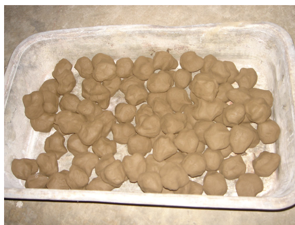
รูปที่ 2 มวลรวมประคิษฐ์ที่ปั้นด้วยมือสำหรับทดสอบความต้านทานการสึกกร่อน ความคงตัว และการดูดซึมน้ำ
