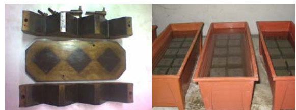
ภาพที่ 2 แบบหล่อตัวอย่างขนาด 2 \times 2 \times 2 นิ้ว และการบ่มก้อนทดสอบในน้ำ
