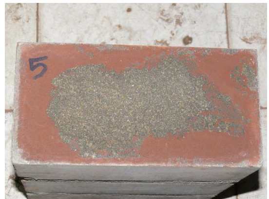
รูปที่ 13 การเชื่อมประสานก้อนบล็อกตันด้วยปูนก่อที่ไม่ดี
