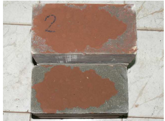
รูปที่ 12 การวิบัติของแท่งตัวอย่างแบบตันใช้การก่อ
