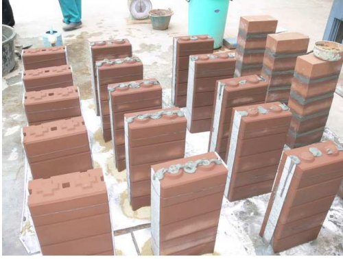
รูปที่ 7 ฐานงานบล็อกประสาณที่ก่อขึ้นรูปแล้วรอบ่มจนครบอายุ ก่อนทดสอบ
