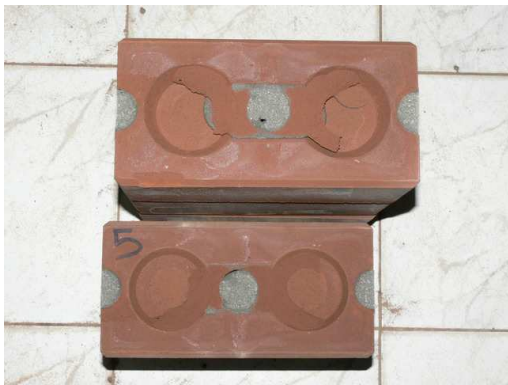
รูปที่ 9 การวิบัติของแท่งตัวอย่างดอกกลมตัน
